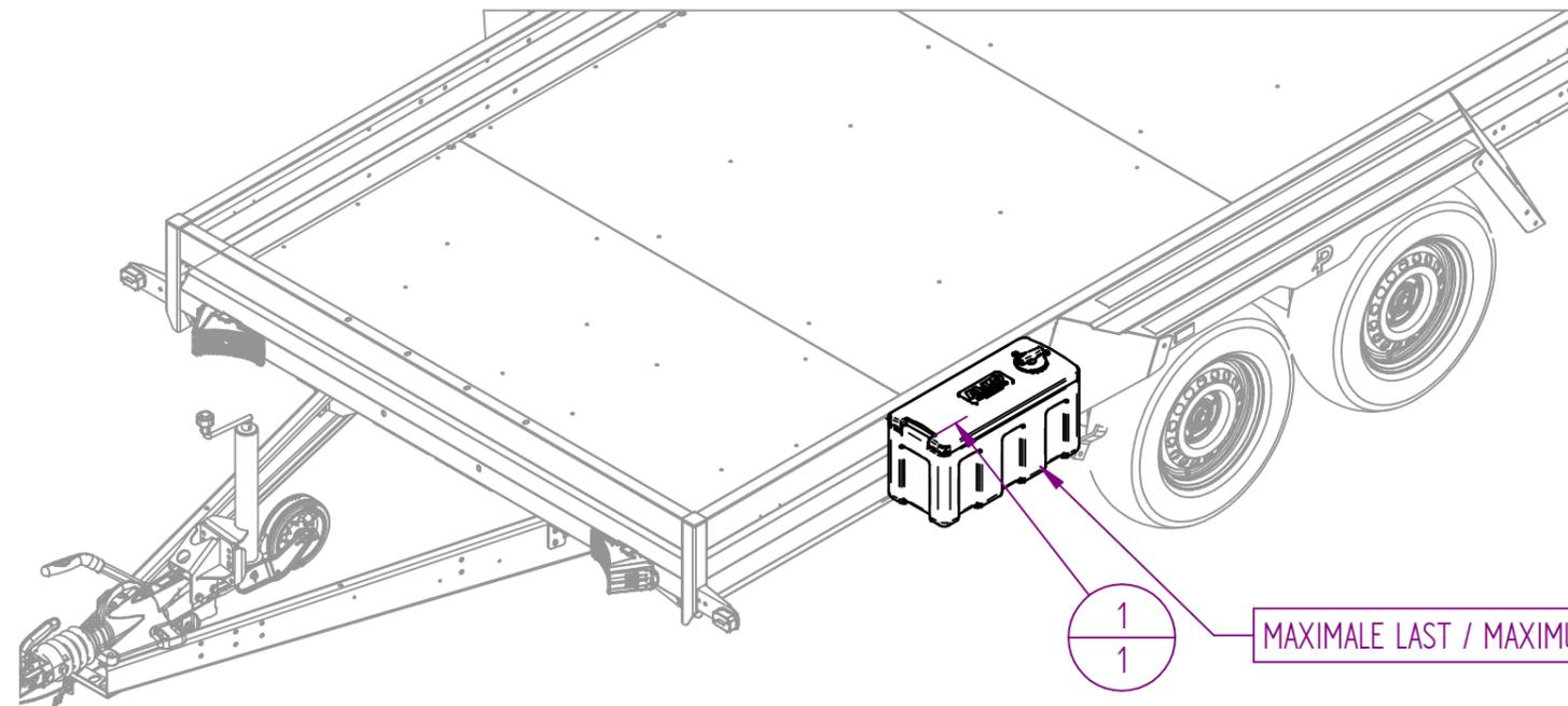
MAXIMALE LAST / MAXIMUM LOAD 25kg
